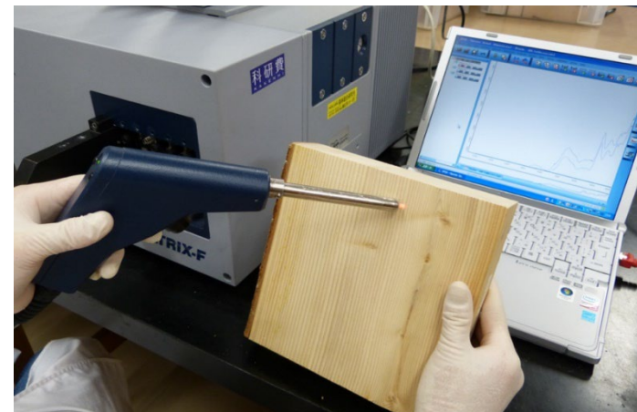
図2 近赤外分光法による非破壊での木材の樹種識別 光が出るプローブの先端を木材の表面に軽く当てて測定します。
