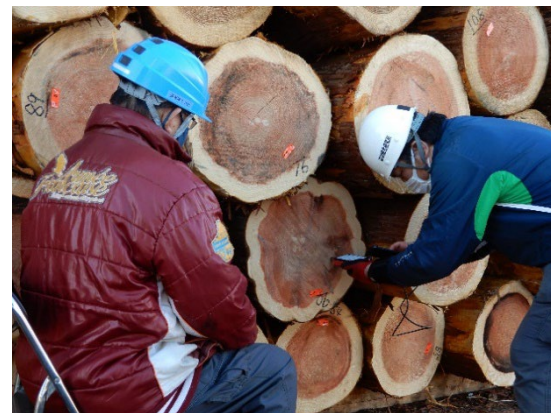
図2 丸太を積み上げた状態でハンディ型測定器を用いて丸太のヤング係数を測定している様子
