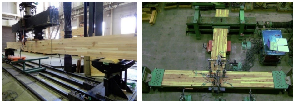
図2 間柱を用いて製造した大断面集成材の強度試験 (左：曲げ強度試験、右：接合性能試験)
