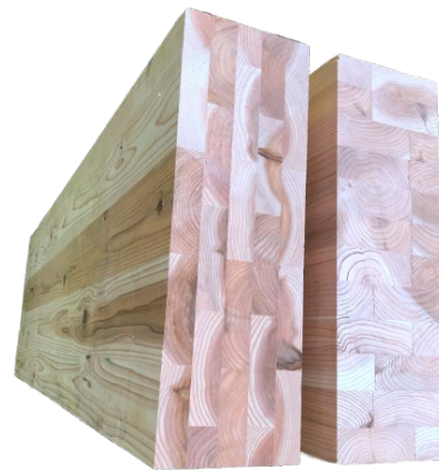
図1 間柱を用いて製造した大断面集成材 原料ひき板にスギ間柱、接着剤に水性高分子イソシアネート系樹脂を用いて製造しました。
