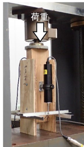
図1 くぎのせん断性能を調べる試験の様子と試験結果の一例 日本ツバイフォー建築協会が定める接合部の試験を実施し、荷重と変形の関係を測定しました。この試験結果から力学的特性値を明らかにしました。
