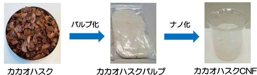
図1 カカオハスクCNFの製造工程 カカオハスクCNFを低コストで製造する技術を開発しました。
