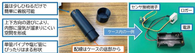
図1 計測デバイスの概要
