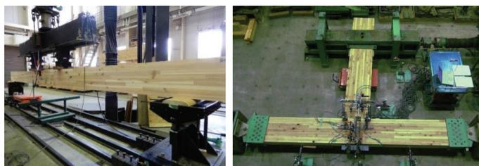
図2 間柱を用いて製造した大断面集成材の強度試験
