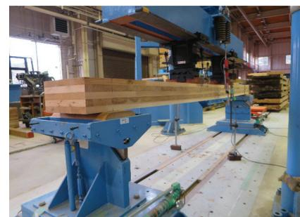
図2 スギーCLTの曲げ強度試験
