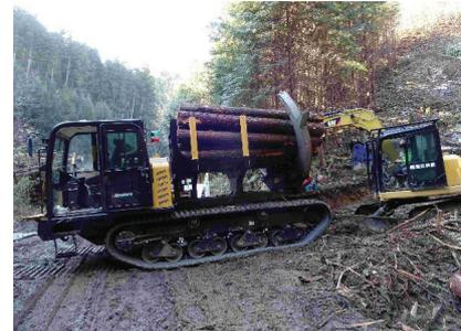
図2 短幹集材兼用型クラムバンクスキッド(短幹材兼用型)
