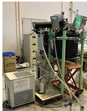
図2 減圧マイクロ波水蒸気蒸留装置
