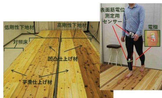
図1 モデル床(左)と歩行時における表面筋電位の測定(右)
