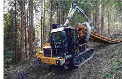
図1 開発したゴムクローラ式クラムバンクスキッド(グラップル搭載型)
