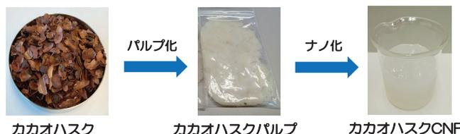
図1 カカオハスクCNFの製造工程
