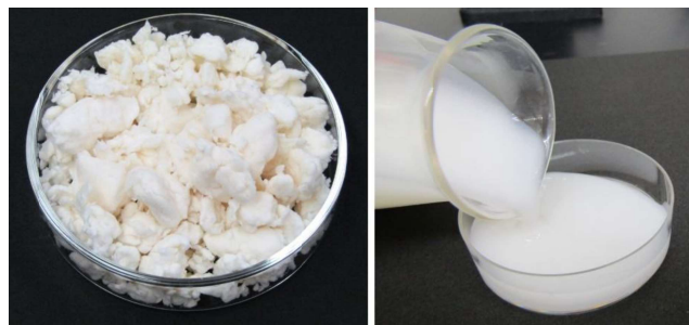
図1 広葉樹材から得られるパルプとCNF コナラのチップから、漂白パルプとナノ化したCNF懸濁液までの一貫製造を行いました。
