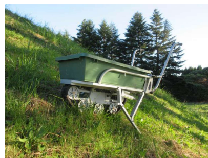
図1 アウトリガを搭載した電動クローラ型1輪車
