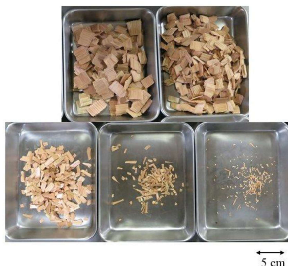
図1 ディスクチッパーで製造されたチップの分級結果の一例
