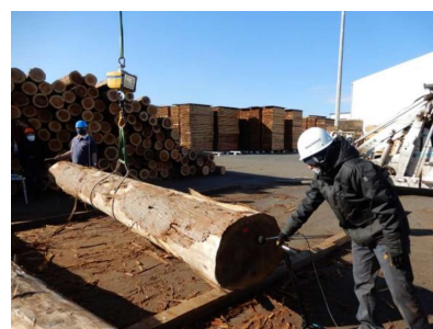
図1 一本ずつ丸太をつり下げた状態でヤング係数を測定している様子
