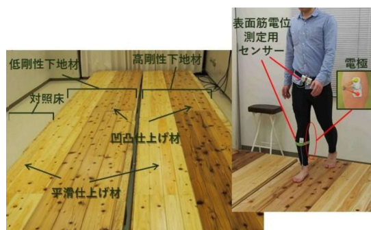
図1 モデル床(左)と歩行時における表面筋電位の測定(右) モデル床での歩行時における足の表面筋電位測定することで床の歩きやすさを評価する手法を開発しました。
