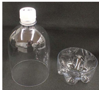
図1 炭酸飲料用ペットボトルから作製した培養植物の馴化用保湿カバー(左)と水受け皿(右)
