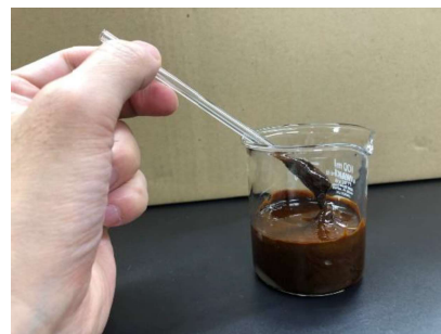
図1 スギ合板製造時の乾燥廃液 スギ単板の高温乾燥により、非常に粘性の高い廃液が得られます。
