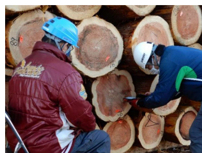
図2 丸太を積み上げた状態でハンディ型測定器を用いて丸太のヤング係数を測定している様子 丸太を積み上げた状態でも測定が可能であることが分かりました。
