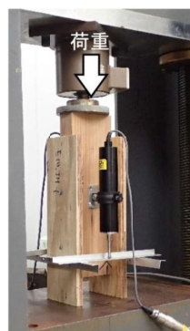
図1 くぎのせん断性能を調べる試験の様子と試験結果の一例 日本ツーバイフォー建築協会が定める接合部の試験を実施し、荷重と変形の関係測定しました。この試験結果から力学的特性値を明らかにしました。
