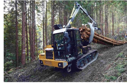
図1 開発したゴムクローラ式クラムバンクスキッド(グラップル搭載型)
