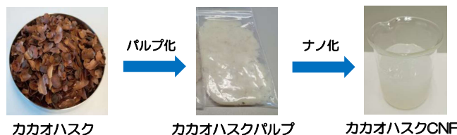
図1 カカオハスクCNFの製造工程 カカオハスクCNFを低コストで製造する技術を開発しました。
