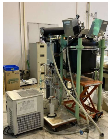
図2 減圧マイクロ波水蒸気蒸留装置 樹皮からの揮発性テルペンの抽出を短時間で効率良く行うことができます。
