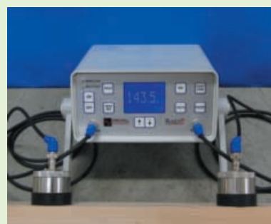
図2 機器による測定の一例 (上:打ち込み型端子、下:接触型端子)
