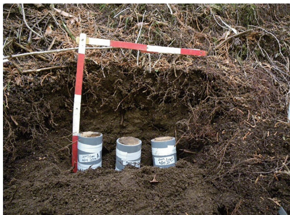
写真1 培養カラムの土壌埋設の様子
