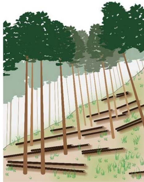
図 4. 間伐木を使った筋工
