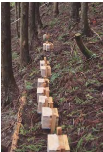
写真3 土砂受け箱の配置
