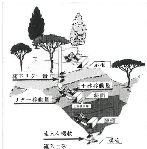
図1 森林から溪流へのリター・土砂の移動量の測定模式図
