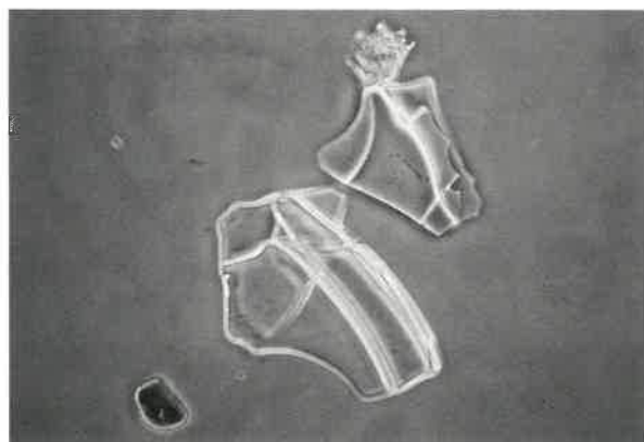
写真 火山ガラス（粒径はおおよそ200 μm）
