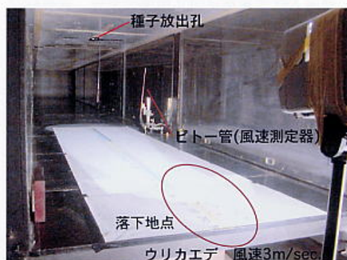
写真1 風洞を使った落下試験 (風洞は縦0.9m、横1.2m)
