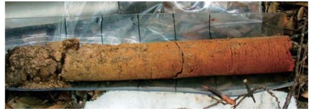
図1 コアサンプリングにより採取された土壌サンプル
