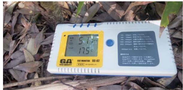
写真1. 二酸化炭素濃度計を設置した様子
