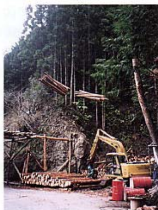
写真1 架線による集材（高知県、都築伸行撮影）
