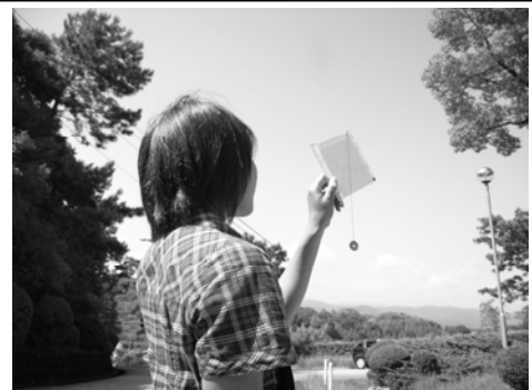
図 6 野外での仰角測定の風景
