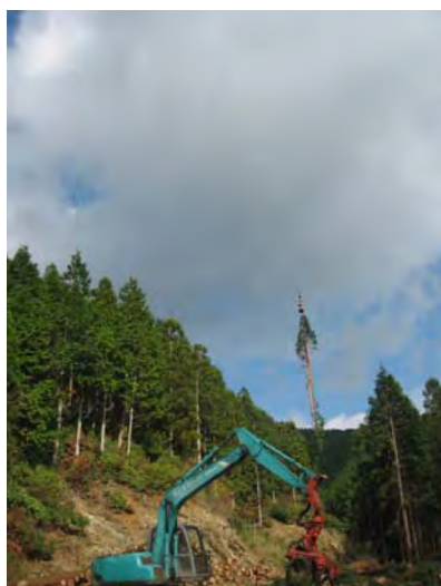
図3 H型架線による木材運搬
