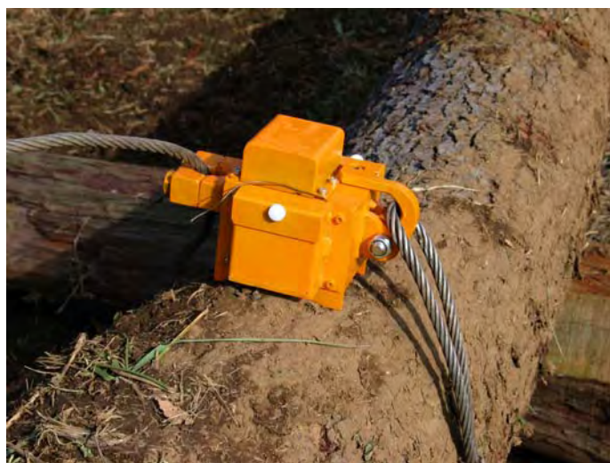
写真-3 無線操作式チョーカフック装置
