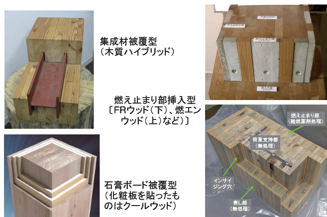
図 1 国土交通大臣認定を取得している耐火機構別 1 時間耐火集成材
