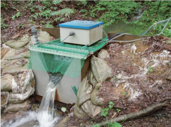
写真1：流出水量を観測するための堰
