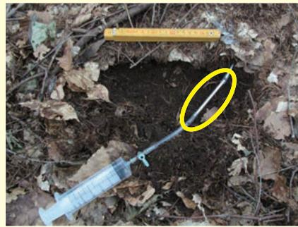
写真2 土壌中のモノテルペン濃度を測定するための土壌空気採取の様子。注射器と土壌の間に見える金属チューブ（黄色く囲んだ部分）にモノテルペンの吸着剤が詰められている。
