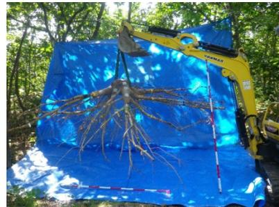
写真16 植栽後40年のケヤキの根系の重量測定
