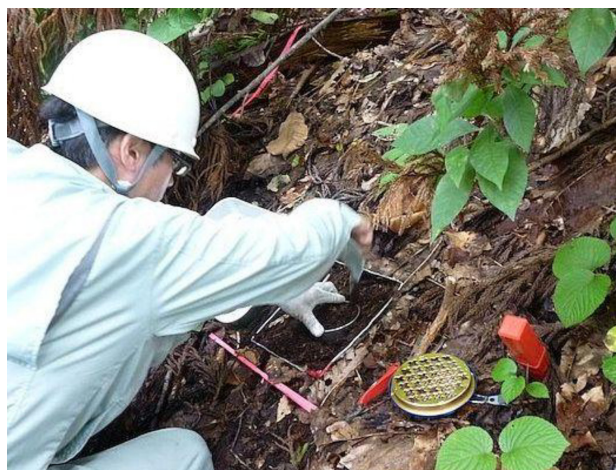
写真 2. 採土円筒による土壌試料の採取 Photo 2. Sampling using a soil sampling cylinder
