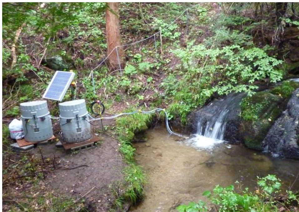
写真 1. 自動採水装置
