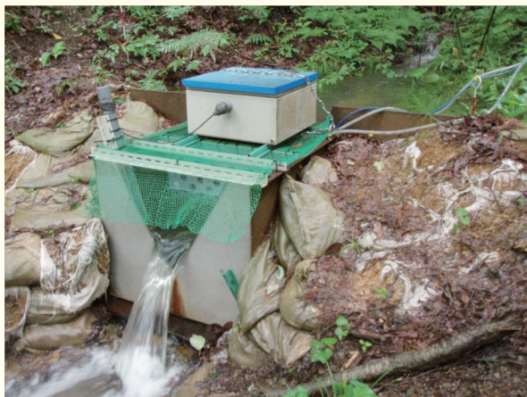
写真1：流出水量を観測するための堰 この写真は、図1の雨とは異なりますが、2014年7月の総雨量90ミリの雨が止んだ直後に撮影したものです。流出水量が多くなっていますが、渓流水はほとんど濁っていません。
