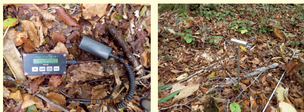
写真2 TDR土壌水分計(左)と土層強度検査棒(右)の測定風景
