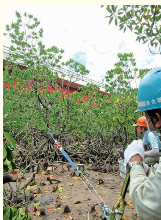
写真2 西表島・浦内川河口におけるヤエヤマヒルギの引き倒し試験の様子
