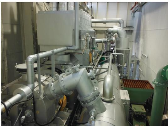
トレファクション処理用炭化炉(写真)を自動制御できるように改造した結果、燃料製造時の温度が安定しました。これによりエネルギー効率も高まり、製造時に必要だった燃料を30%削減することができました。
