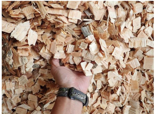
写真2 燃料利用のためチップ化されたアカマツ被害材
