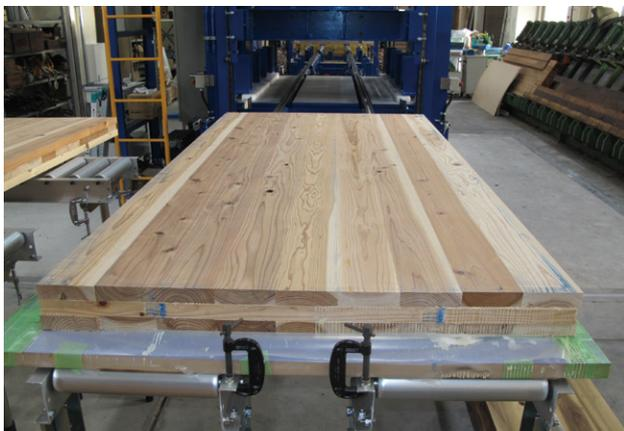
CLTの製造工程の効率化について小サイズの試作機を用いて実証しました。
