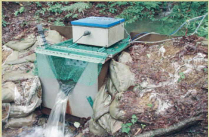
写真 流出水量を観測するための堰
