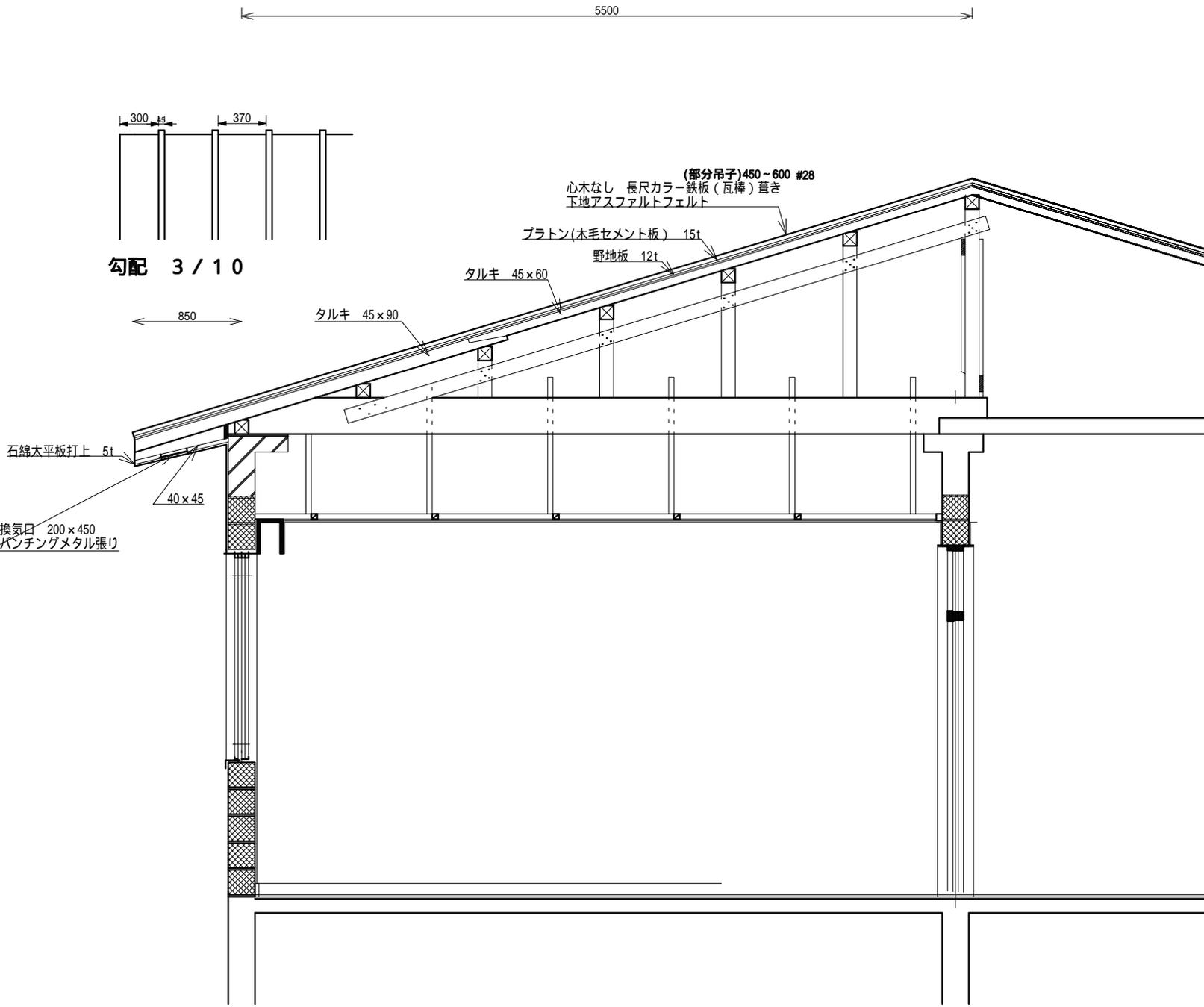
鳥獣実験室矩計図(新築時:屋根部分抜粋)
