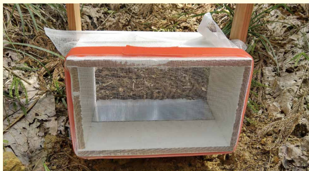
写真-2 土砂受け箱外観 背面にはメッシュを固定し、雨水のみを透過させるようにしている
