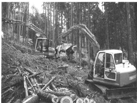
図2 造材時に集材路脇で発生した枝条・タンコロ（写真左下）
