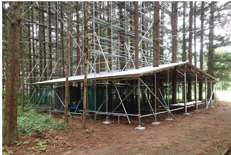
写真1 高さ20mのスギ林（約40年生）に設置した降雨遮断施設
