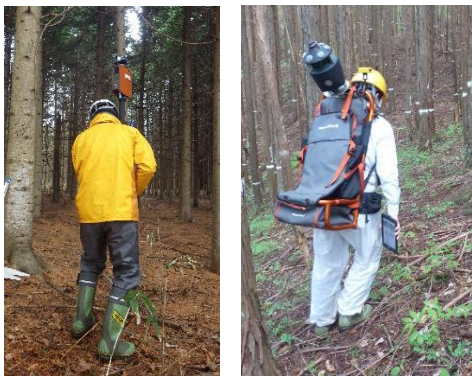
図1 TLSによる森林計測の様子
