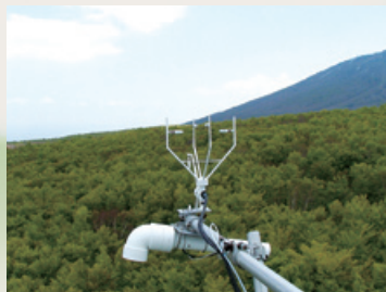
写真 ブナ林におけるCO 2 収支の観測タワー（岩手県八幡平市安比）
