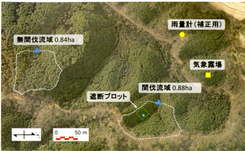
図1 常陸太田試験地内の間伐試験流域。スギ・ヒノキの人工林。間伐流域は1987年植栽、無間伐流域は1924年植栽。気象露場において降水量、遮断プロットにおいて樹冠通過雨量と樹幹流下量を観測。▲は量水堰（60°三角堰）設置地点を示す。
