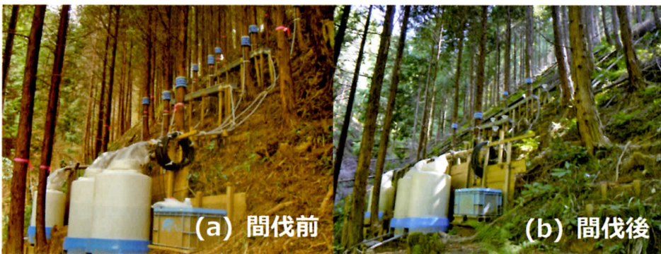
図2 (a) 間伐前、(b) 間伐後の遮断プロット内の様子。大型雨樋で樹冠通過雨、樹木周囲（間伐前10本、間伐後5本）に巻いたウレタンマットで樹幹流下雨を集め、大型タンクに導水して貯留量を測定した。
