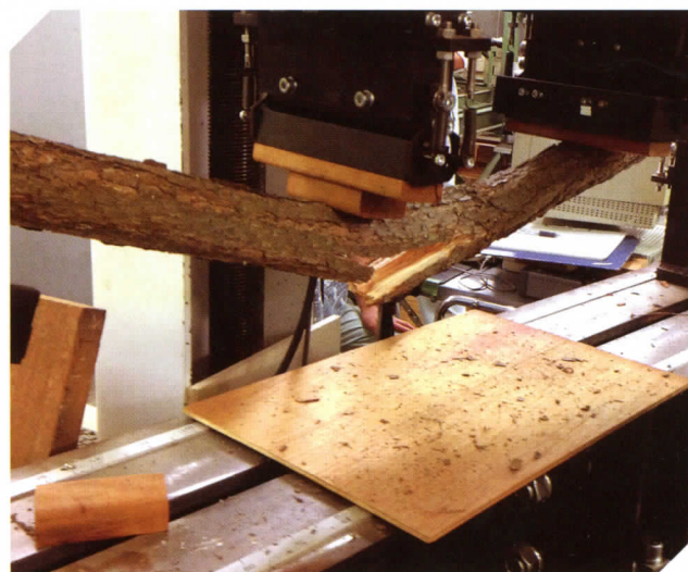
写真2 曲げ破壊試験の様子
