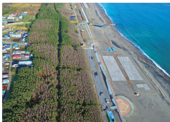
写真1 塩水害によるクロマツ生存木の立ち枯れ 津波のあと針葉は緑色だったが、夏ころから赤褐色になり、多くのクロマツが枯死した（約20カ月後：2012年11月19日）。
