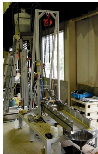
写真4-3 可変勾配水路
