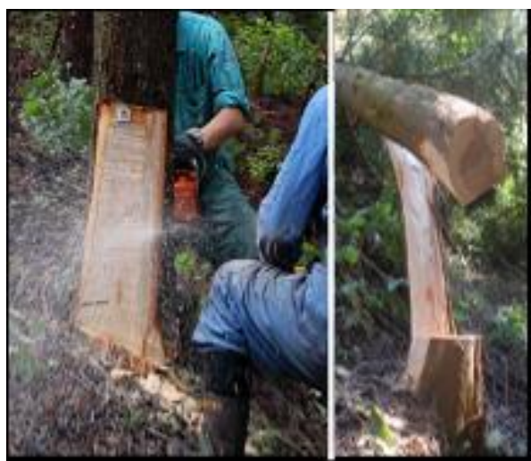
図 2-1-4 伐倒時の裂け上がりのようす
