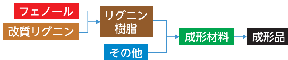
図2 改質リグニン利用樹脂を用いた成形品の試作方法の概略
