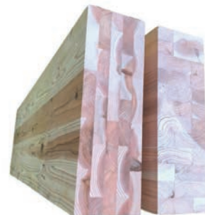
図4 間柱を用いて試作した大断面集成材 断面寸法：150mm（幅）×450mm（高）
