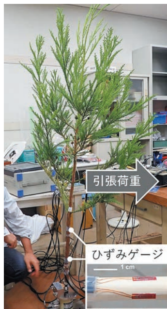
図2 荷重試験のようす。幹にひずみゲージを貼り付けておくことで、幹が力を受けて曲がった時の変形量を計測することができる。
