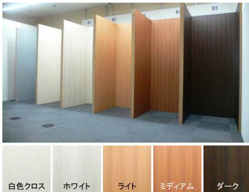
図1 色の違う木目模様のシートを貼った「ブース」 高さ約 2.1m、幅約 0.9m のブースを作成し、女性被験者に中に入って 壁面を眺めてもらいました。
