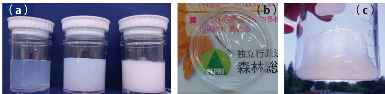
図3 酵素処理と機械処理を併用して得られたタケセルロースナノファイバー (a) セルロース懸濁液（左から 0.06%、0.6%、1.2%）、(b) フィルム、(c) ゲル
