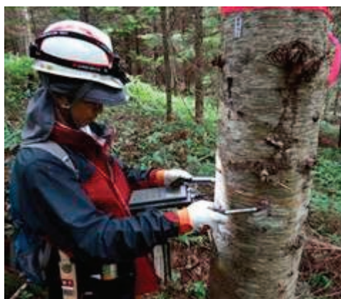
写真2 立木状態で非破壊的に心材含水率を推定している様子
