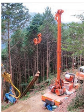
図1 タワーヤーダ 搬器が木を吊り上げている様子
