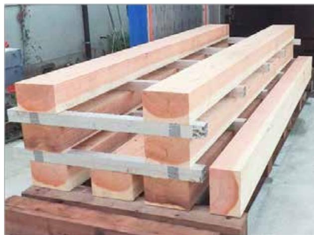
図4 乾燥試験に用いたスギ平角材
