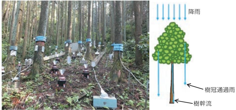
図1. スギ壮齢林分における遮断蒸発の計測
