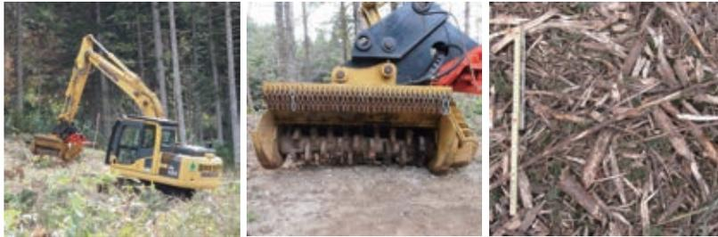
図1. エクスキャタに装着したクラッシャと、クラッシャ地ごしらえで堆積する破砕物
