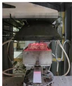
図4. 舗装材の燃焼性を評価する
