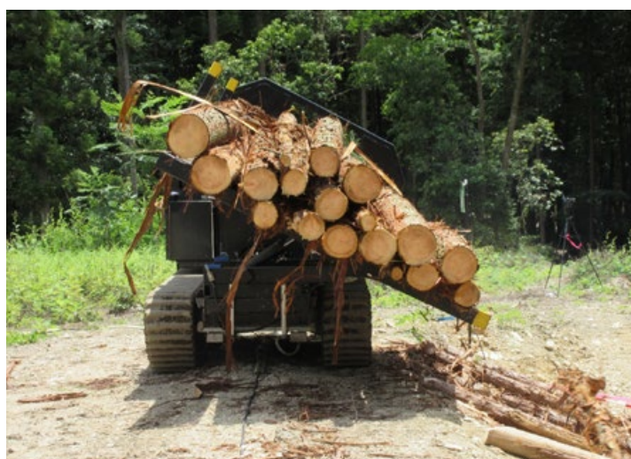
図3. 自動荷おろし作業中のフォワーダ
