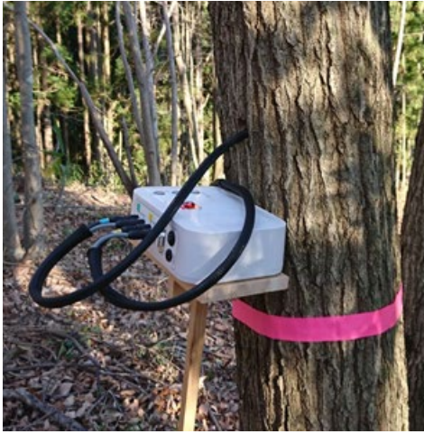
図1. 伐倒せずに樹木の放射性セシウム濃度を測定できる可搬型検査装置
