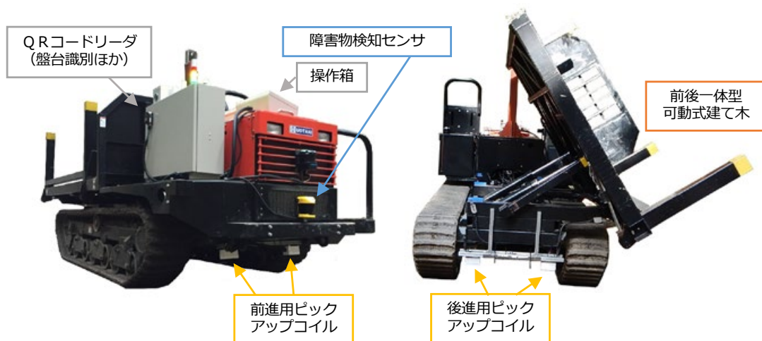
図1. 開発したフォワーダの外観図
