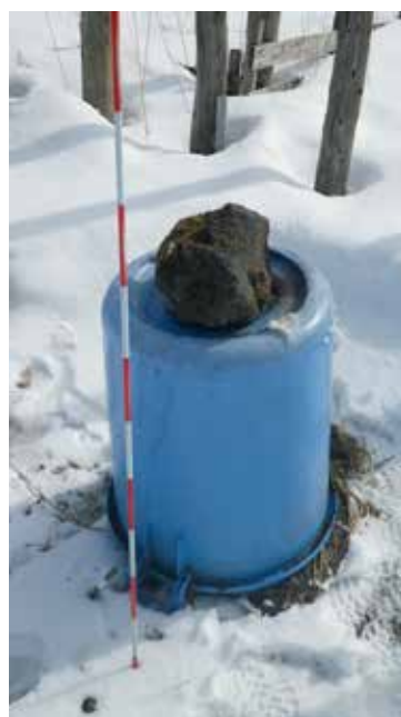
図4 積雪のある状態での地中温度の実測の様子
