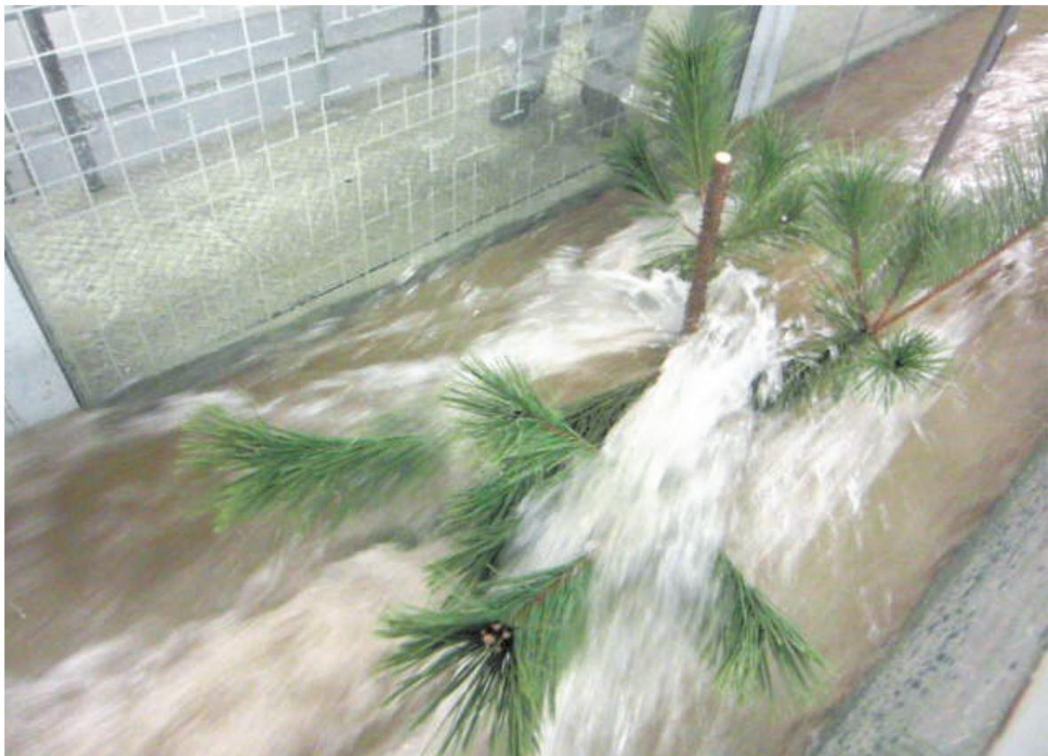
写真 1 実物樹木を対象とした水理実験の様子
