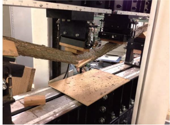
写真4 曲げ破壊実験の様子
