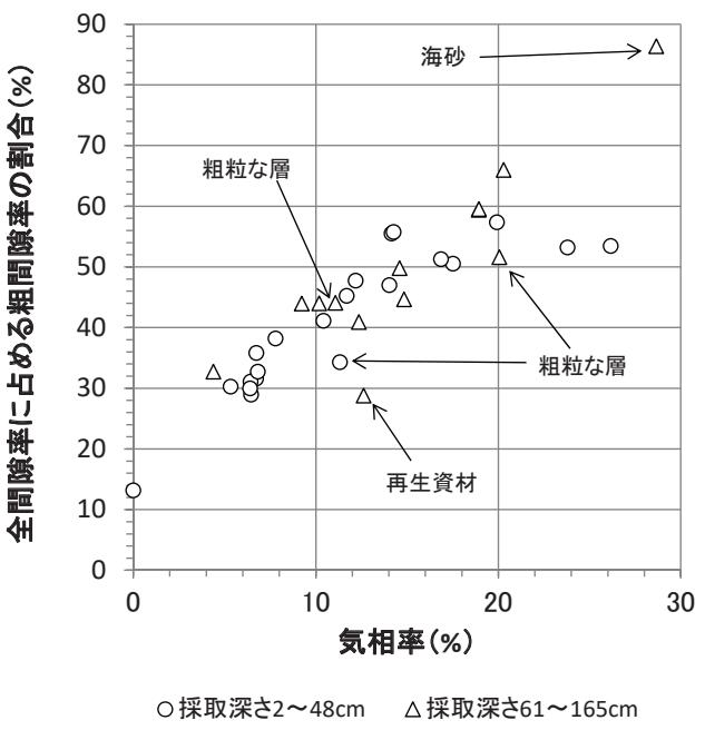
Fig. 8. 気相率と全間隙率に占める粗間隙率の割合との関係
