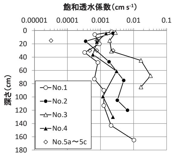
Fig. 6. 盛土の飽和透水係数の鉛直変化
