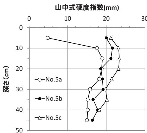
Fig. 2. 盛土の硬度指数(山中式土壤硬度計)の鉛直変化
