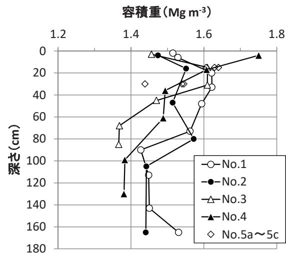
Fig.3. 盛土の容積重の鉛直変化
