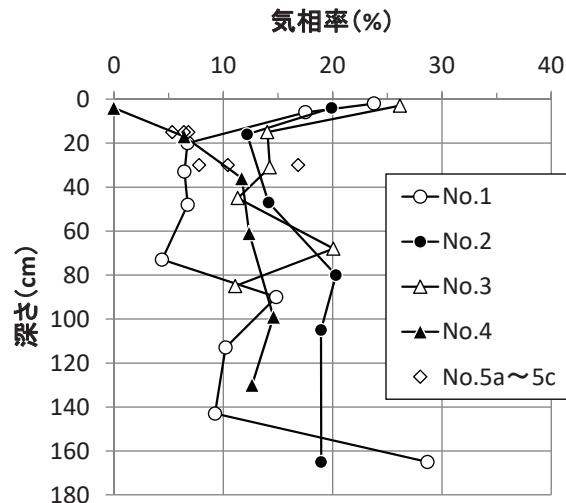
Fig.4. 盛土の気相率の鉛直変化
