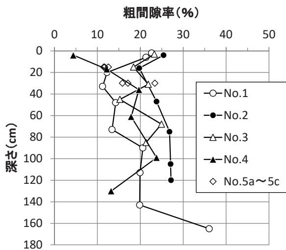
Fig. 5. 盛土の粗間隙率の鉛直変化
