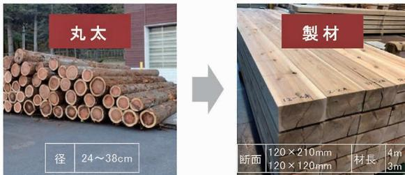
写真2 試験に用いた丸太と製材
