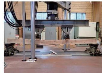
写真3 曲げ試験の実施状況
